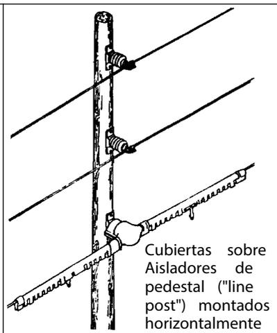
Cubiertas sobre Aisladores de pedestal ("line post") montados horizontalmente
