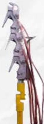
Sistema patentado de colocación de pinzas una encima de otra, brindando mayor maniobrabilidad en la operación y reduciendo el esfuerzo del operario.
